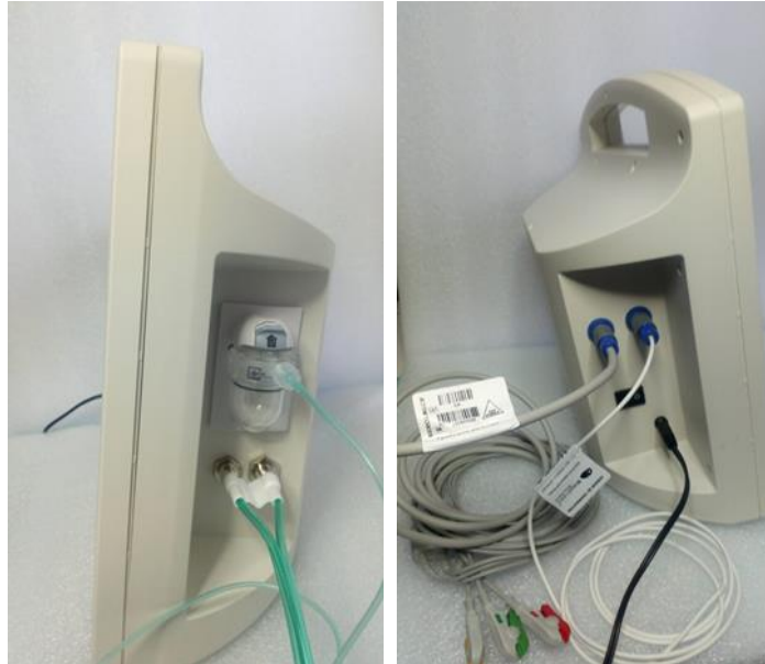
Figura 2. Vistas laterales del equipo para (izquierda) los sensores neumáticos y la trampa de agua y (derecha) sensores eléctricos y fuente de alimentación.
