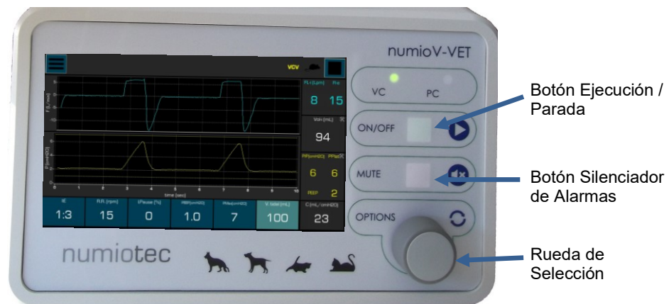
Figura 2: Botones de control en el panel frontal del ventilador
